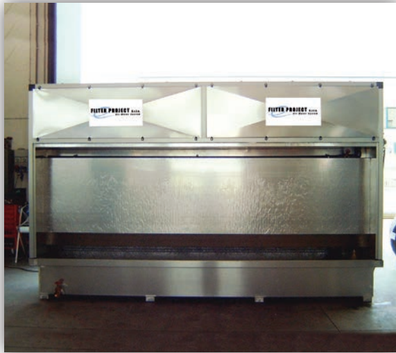
CABINA ASPIRANTE ACQUA 4 MT WATER SUCTION WALL 4 MT
