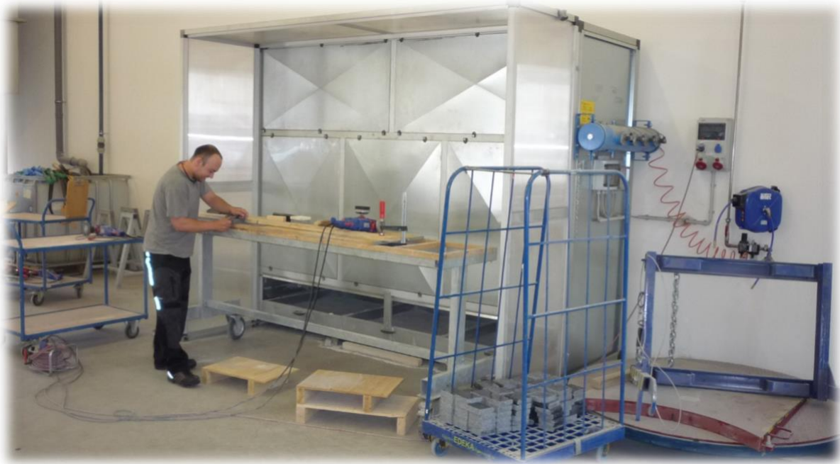
(Foto zeigt Vorbau aus Polycarbonat an einer Trockenabsaugwand.
